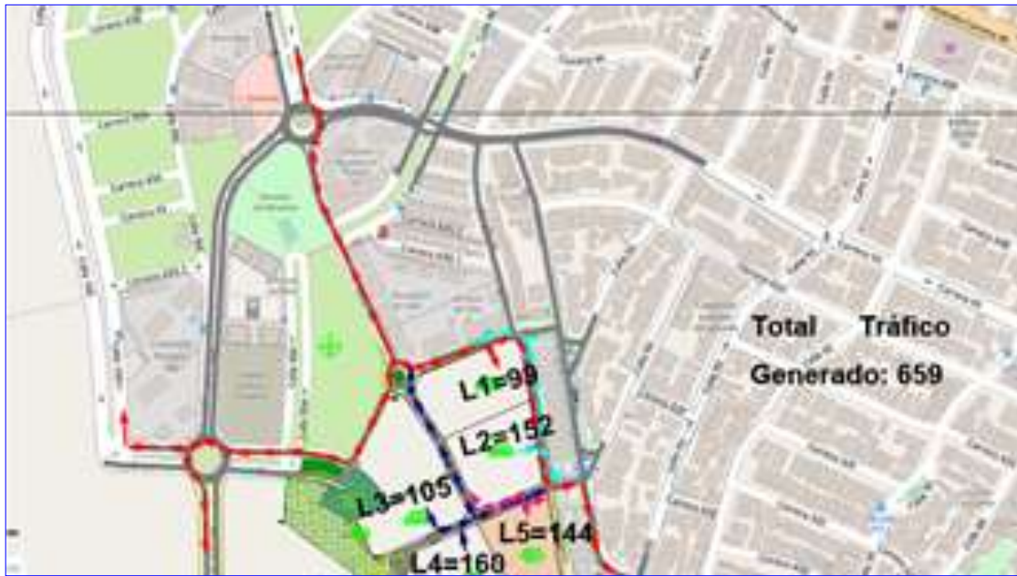
Ilustración 71 Asignación de Flujo generado y rutas típicas del Plan Parcial Bosques de Miramar.
