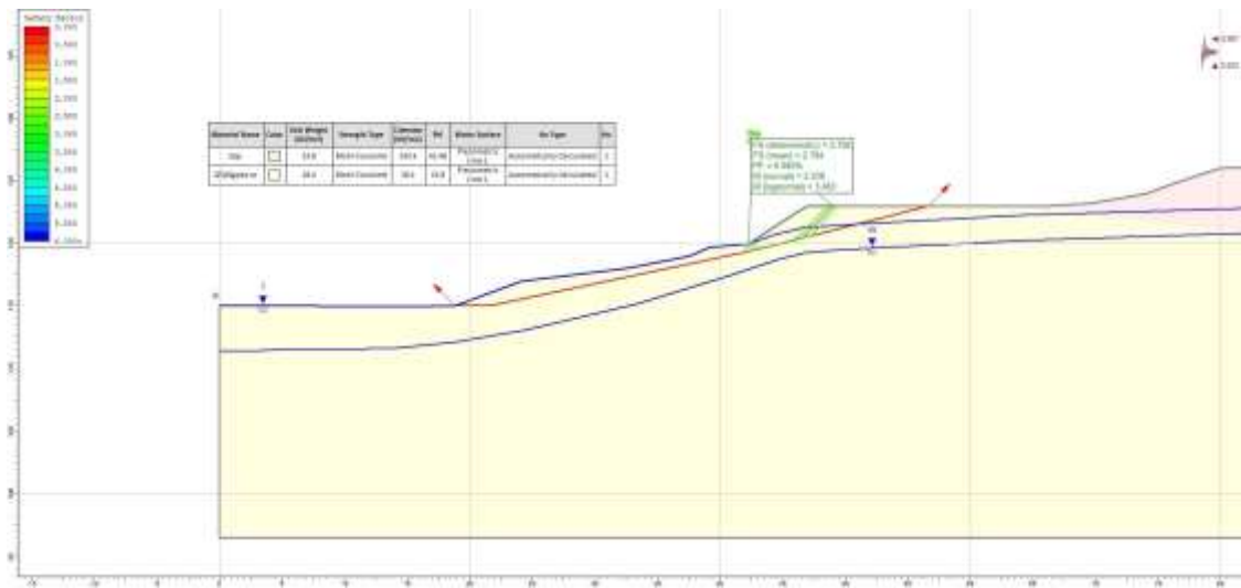
Figura 7.3 Análisis de Estabilidad por Falla Traslacional – Sección 1-1' Escenario Actual - Talud Saturado con Sismo
