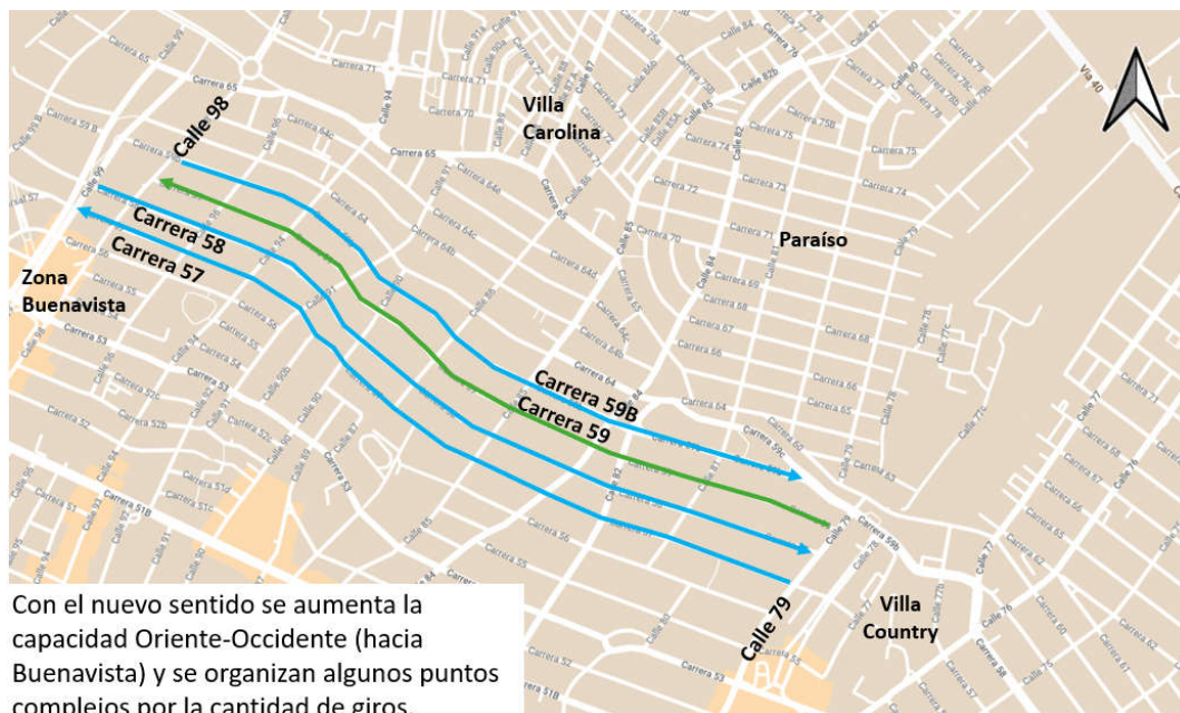
Ilustración 15 Sentido propuesto para la Carrera 59 (oriente – occidente)
