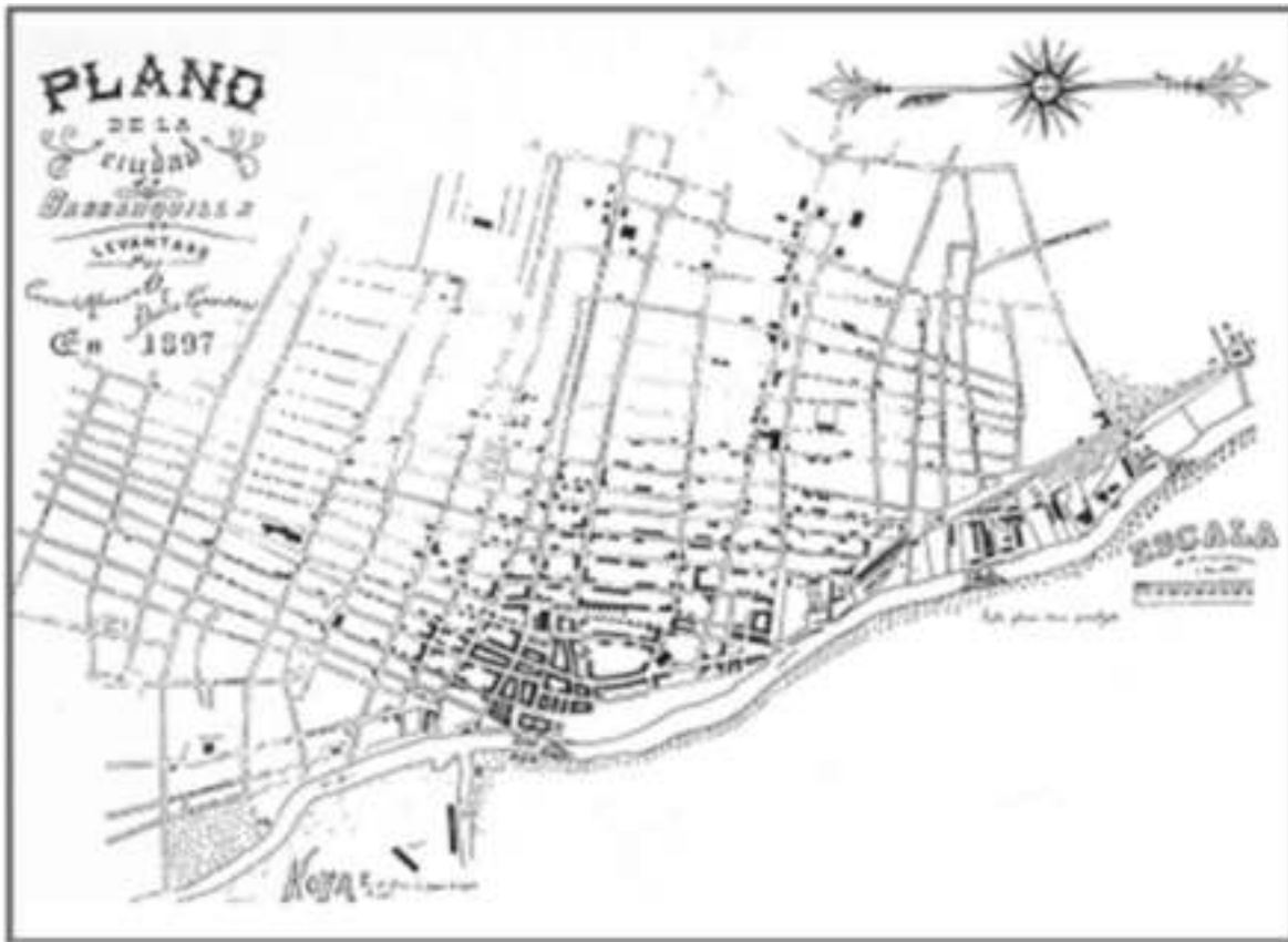
Figura 34. Plano de 1897 en el que se identifican en las manzanas los inmuebles en mampostería como sombras oscuras y los inmuebles en bahareque y techo de paja, en color blanco
