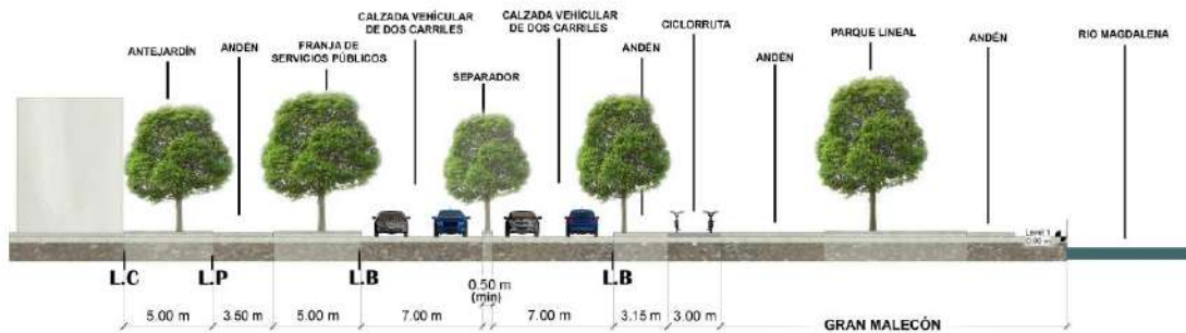
Figura 61 Sección Tipo Perfil AVR Fuente: Elaboración Propia
