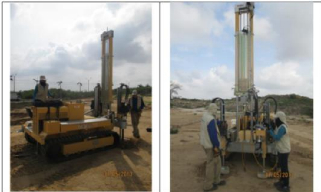
Imagen 05. Piezocono Sísmico. PAGANI. Fuente: Estudio hidrogeomorfológico. C.I. Ambiental. S.A.S.
