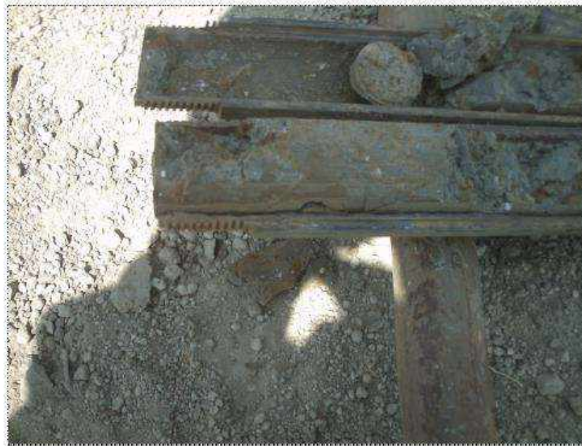
IMAGEN 5 - MUESTRA DE ARCILLA COLOR GRIS CON VETAS AMARILLAS EXTRAÍDA DEL SUBSUELO
