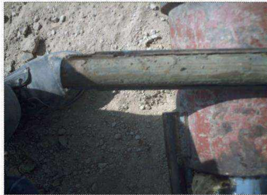
IMAGEN 7 - MUESTRA DE ARCILLA DE ALTA COMPRESIBILIDAD COLOR GRIS
