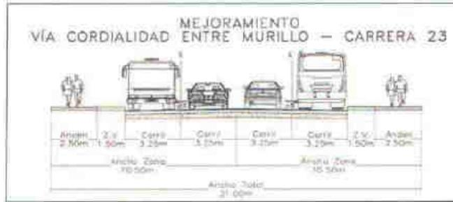
Sección transversal típica entre Murillo y Carrera 23
