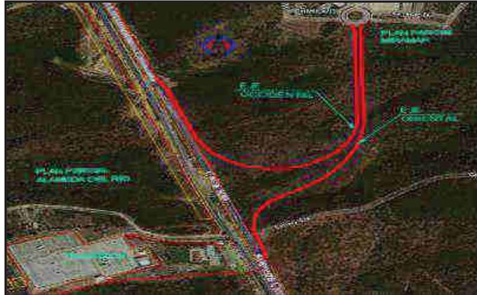
Se construirán los enlaces de conexión con una sección de dos carriles por sentido con separador central, espacio público y zonas verdes laterales, como se muestra en la siguiente imagen:
