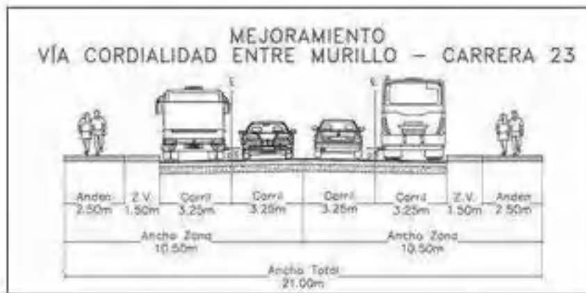
Sección transversal típica entre Murillo y Carrera 23
