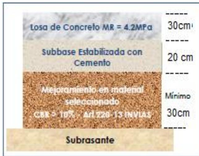
Previo al mejoramiento de la subrasante con el relleno en material seleccionado, se debe renivelar y recompactar la subrasante para posteriormente colocar el geotextil y de inmediato proceder a la colocación del material seleccionado.
