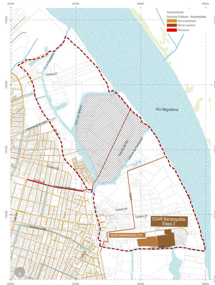
Figura 127. Sistema de Alcantarillado en el POZ La Loma - Barranquillita.
