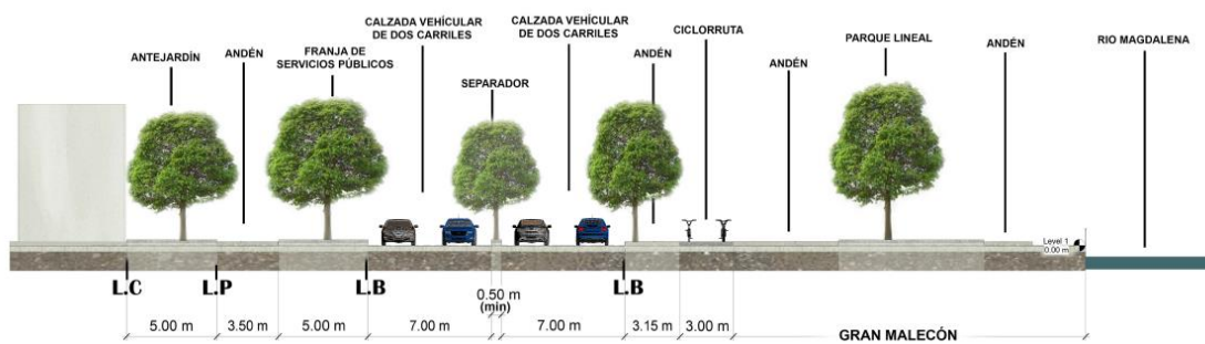
Figura 106 Sección Tipo Perfil AVR Fuente: Elaboración Propia
