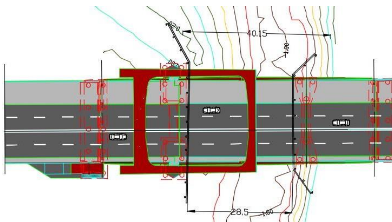
Figura 6-5. Contracción del Cauce por Efecto del Puente Móvil. Fuente: Diseños Contratista
