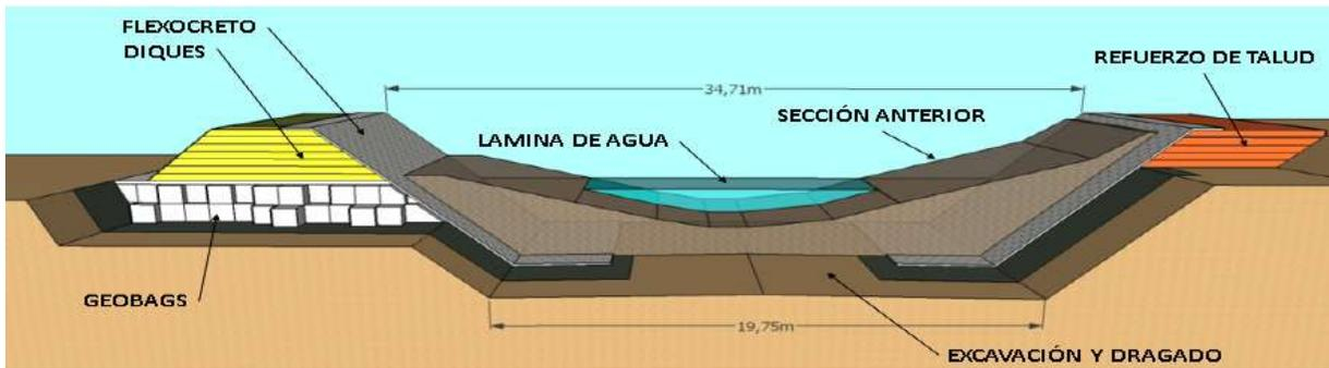
Ilustración 23. Recuperación Integral del caño de la ahuyama.
