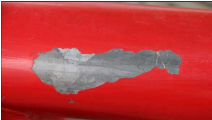
Fotografía 214. Detalle de uno de los elementos metálicos de la máquina deportiva denominada "esquí", registrada en la imagen anterior. La pérdida de esta capa de pintura no solo altera la parte estética de la máquina, sino que facilita el ataque de los agentes externos ambientales sobre el acero de este equipo.
