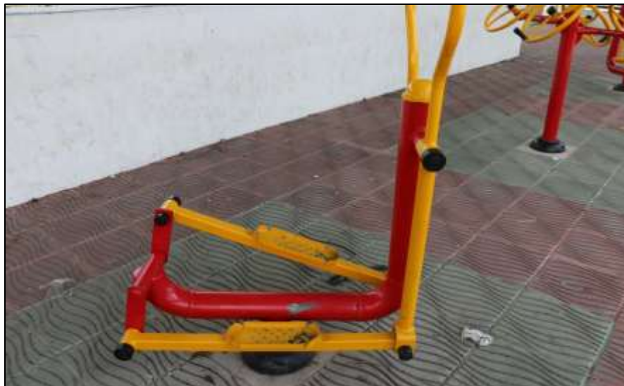
Fotografía 213. Vista general de la máquina deportiva denominada "esquí", instalado en el polideportivo intervenido por medio de este contrato de obra. Se evidenció deterioro prematuro de estos aparatos, específicamente, pérdida parcial de pintura de acabado, por desprendimiento. Lo anterior, por baja calidad de este material.
