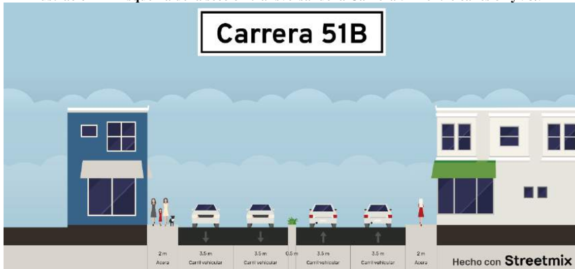
Ilustración 1 – Esquema de la sección transversal de la Carrera 51B entre calles 84 y 93/94
