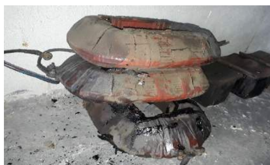
BOBINAS DE CAMPO QUEMADAS
